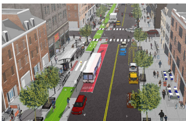
图 5-25 国外案例：完整街道(complete street)设计方案示意图
